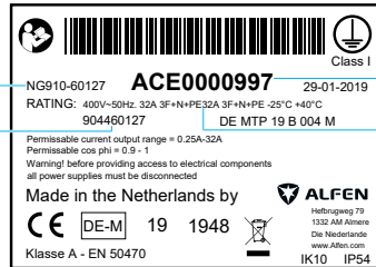
Abbildung 3.2: Typenschild für Ladestation mit festem Ladekabel
