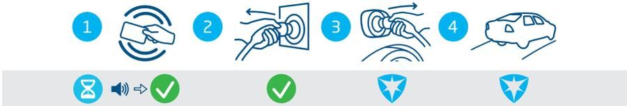
Abbildung 4.3: Beenden des Ladevorgangs. Auf der Benutzeroberfläche angezeigte Symbole
