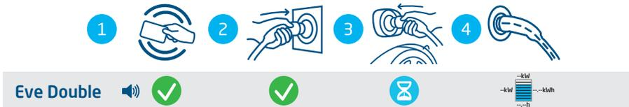
Abbildung 4.2: Starten des Ladevorgangs mit Benutzerberechtigung/RFID-Karte. Auf der Benutzeroberfläche angezeigte Symbole
