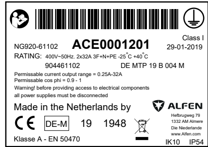
Abbildung 2.15: Typenschild für Eve Double Pro-line mit 2 Versorgungskabeln in der Einspeisung
