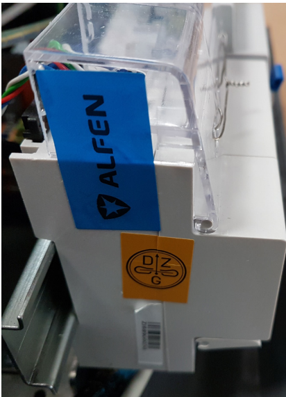
Abbildung 3.1: Lage der Herstellersiegel
