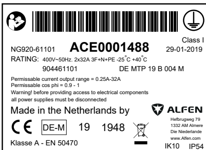
Abbildung 2.14: Typenschild für Eve Double Pro-line mit 1 Versorgungskabel in der Einspeisung
