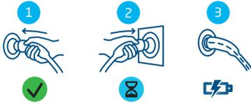
Figura 4.4: Avvio del processo di ricarica senza carta RFID. Simboli visualizzati sull'interfaccia utente
