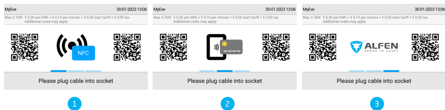
Figura 3.1: Opzioni di pagamento visualizzate in modo alternato sullo schermo delle infrastrutture di ricarica
